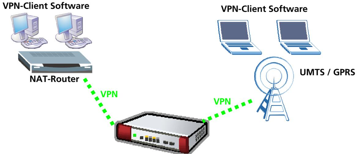
Seit der Firmware 4.00 (Patch 7 für ZyWALL 5, 35 und 70) ist es möglich, mehrere VPN-Tunnels aus dem gleichen Subnetz aufzubauen.
